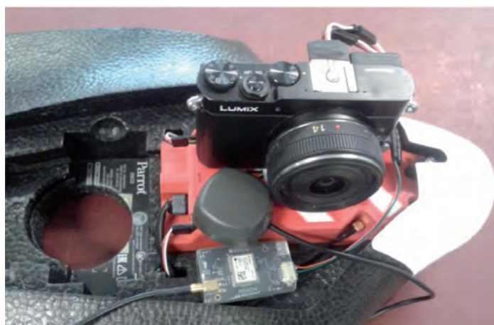
Figura 11 - Drone "commerciale" allestito con camera fotografica, ricevitore GNSS con antenna e dispositivo di sincronizzazione.
