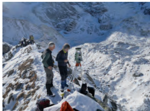
Figura 2 - Rilievo con stazione totale.
