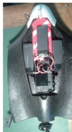
Figura 11 - Drone "commerciale" allestito con camera fotografica, ricevitore GNSS con antenna e dispositivo di sincronizzazione.
